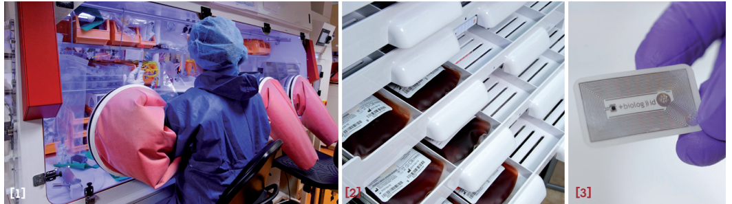
[1] Unité de reconstitution dans un centre de lutte contre le cancer. [2] Enceinte de stockage intelligente. [3] Étiquette RFID.
